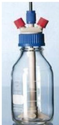
Matières utilisées : PP et PTFE. Système modulaire flexible. Quatre diamètres de tube différents (1,6 mm ; 3,0 mm ; 3,2 mm et 6,0 mm) peuvent être raccordés. Possibilité de compensation stérile de pression grâce au filtre à membrane. Les ports non utilisés peuvent être pourvus d'un capuchon aveugle.
